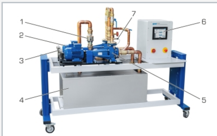
1 caudalímetro electromagnético, 2 motor de accionamiento, 3 sensor de fuerza, 4 depósito de reserva, 5 bomba, 6 pantalla táctil, 7 sensor de presión
